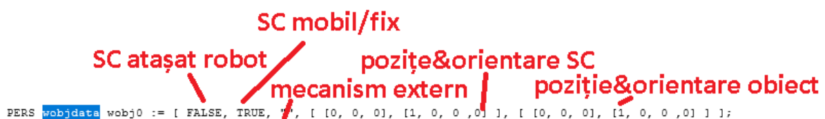
Fig.4-11 – Structura de date folosită pentru memorarea unui punct sistem de coordonate
