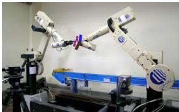
Fig. 8-16 – Roboți cu mișcări coordonate (un robot se mișcă într-un sistem de coordonate manipulat de un al doilea robot)
