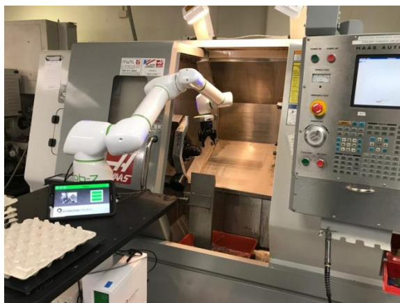
Fig. 8-9 – Soluție automată de alimentare a unei mașini cu comandă numerică (CNC) folosind un braț robotic articulat vertical
