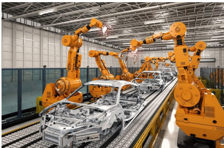
Fig. 8-2 – Utilizarea de roboți industriali pentru fixarea prin sudare a unei caroserii
